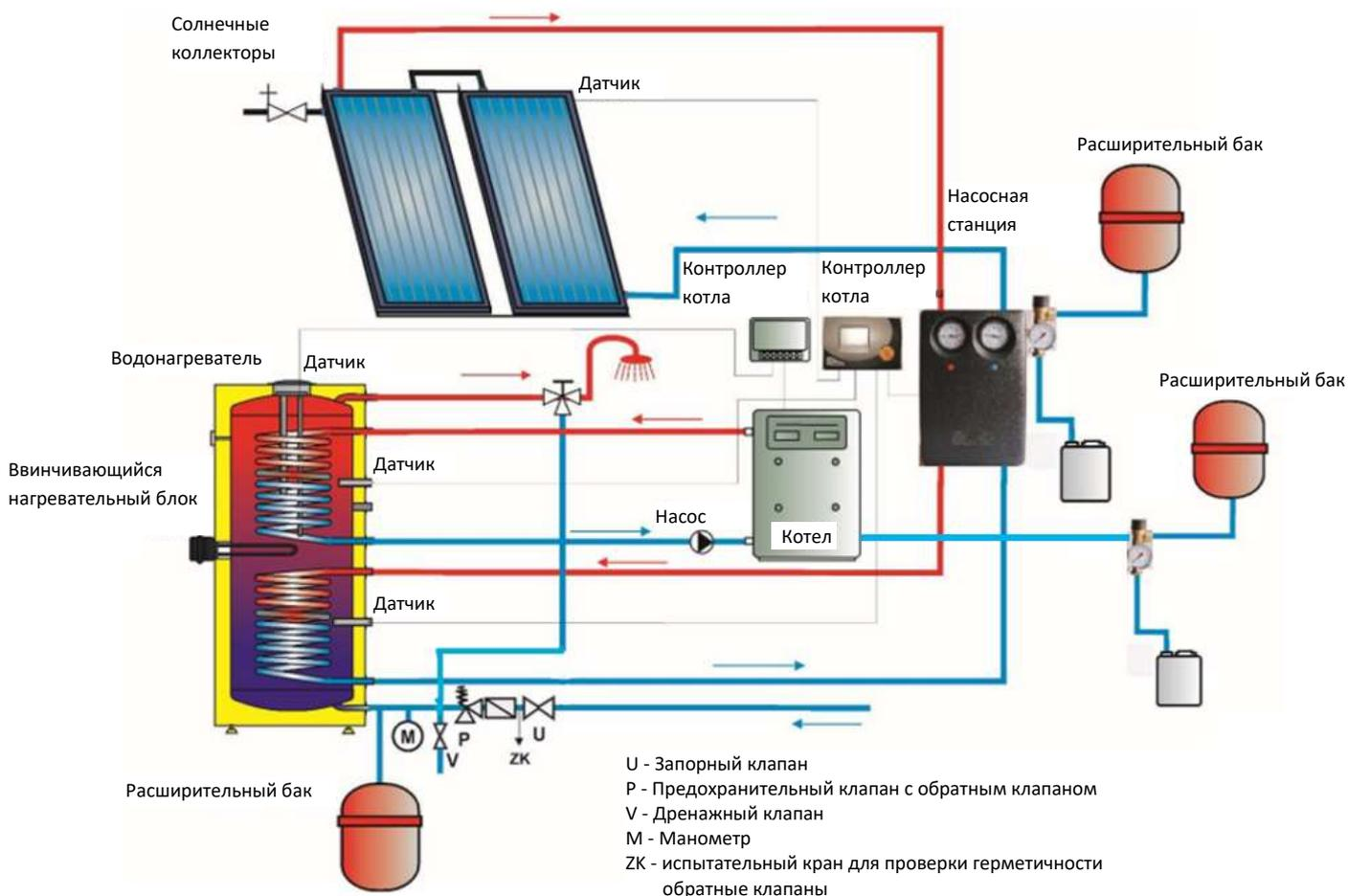
**Примечание:** В случае добавления электрического нагревателя необходимо добавить предохранительные клапаны на оба теплообменника
