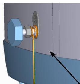
Водонагреватель подключается к электрической сети 3 PEN AC 400 В/50 Гц постоянно прикрепленным подвижным проводом.
