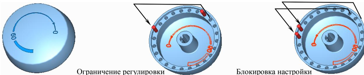
Блокировка настройки – установите выбранную температуру потянув к себе, снимите диск переключателя термостата без изменения настройки, на обратной стороне диска переключателя найдите два штифта, оба выньте и вставьте в отверстия, соответствующие выбранной температуре, таким образом, чтобы между штифтами не было отверстия, и они располагались напротив настроенной температуры.
