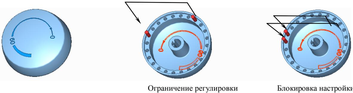
Блокировка настройки – установите выбранную температуру потянув к себе, снимите диск переключателя термостата без изменения настройки, на обратной стороне диска переключателя найдите два штифта, оба выньте и вставьте в отверстия, соответствующие выбранной температуре, таким образом, чтобы между штифтами не было отверстия, и они располагались напротив настроенной температуры.
