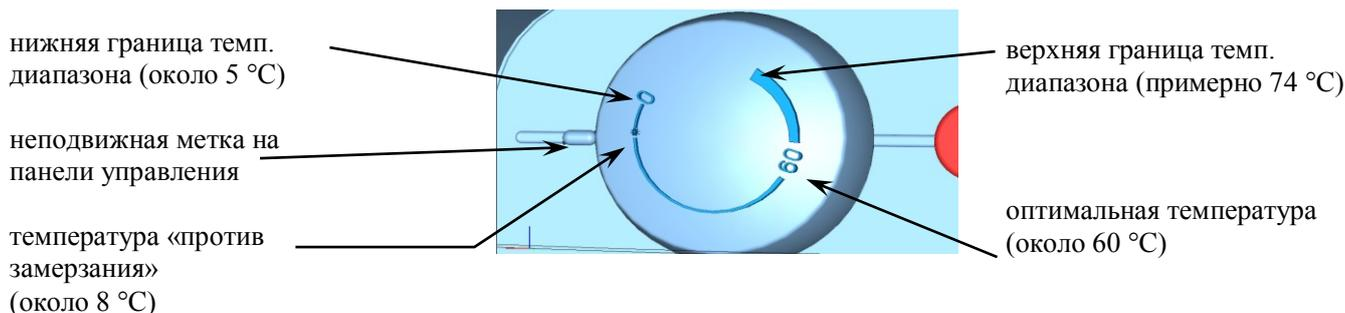
**Предупреждение:** установка переключателя термостата на левый упор не означает постоянного выключения нагревательного элемента.
