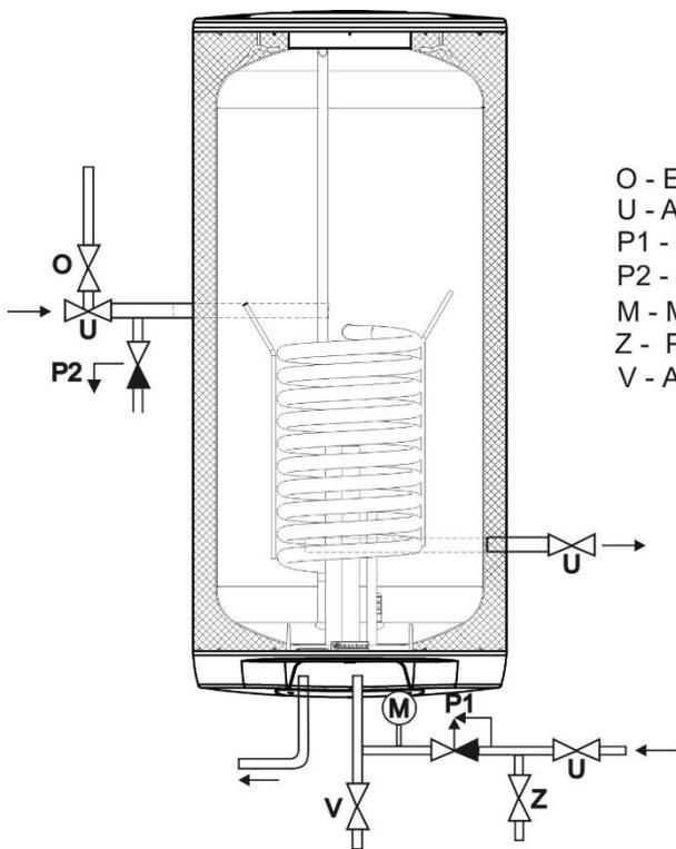
Es ist zweckmäßig, wenn am Heizwasserzulauf und -auslauf Absperrventile eingesetzt werden (für den Fall einer Demontage des Warmwasserspeichers). Die Ventile sind möglichst nahe am Warmwasserspeicher einzusetzen, um größere Wärmeverluste auszuschließen.
