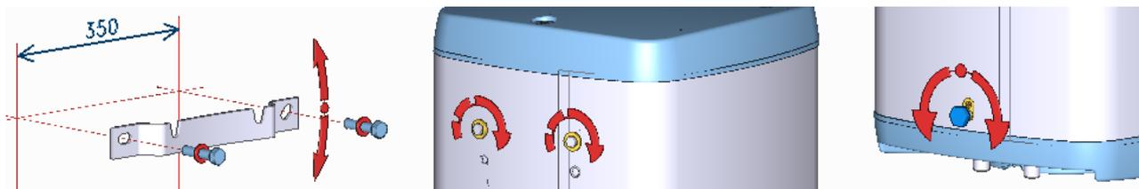
Wird das Wassererhitzer in einen **engen, kleineren Raum** oder in die Zwischendecke montiert, muss man unbedingt beachten, dass die Anschlussseite des Gerätes (Wasser- und Stromanschluss) frei zugänglich bleibt und kein Wärmestau entsteht. Unter dem Gerät muss Freiraum bleiben, der bis zu 500 mm von der Geräteunterkante reichen muss. Bei der Montage direkt unter die Decke muss der Abstand von der Decke min. 50 mm betragen.
