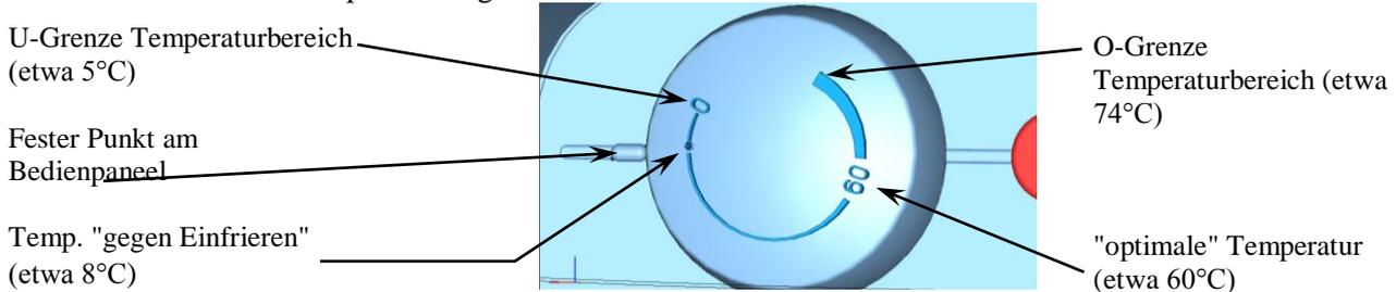
**Hinweis:** Die Einstellung des Thermostatknopfs nach links bis zum Anschlag bedeutet nicht die Abschaltung des Heizkörpers.
