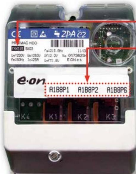
Označení typu přijímače HDO.
