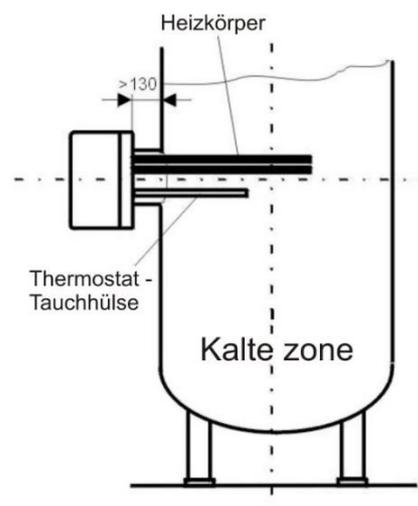
Der Flansch ist zu lang und zu hoch angeschweißt. Thermostattauchhülse unter dem Heizkörper.
