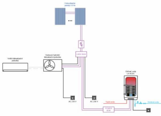
Schéma: přímé využití energie z fotovoltaických panelů
