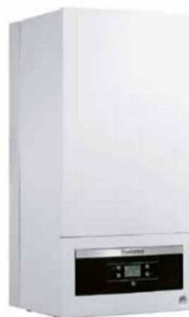
BUDERUS Logamax GB 062-24 (provedení o výkonu 24 kW kombi) – nástěnný plynový kondenzační kotel pro topení a ohřev TUV. Teplota vody 40–60 °C (BUDERUS)
