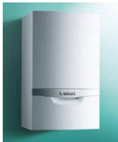
Závěsný plynový kondenzační kotel ecoTEC plus pro vytápění s průtokovým ohřevem teplé vody, s širokou modulací výkonu 17–100% a vysokou účinností až 108% (VAILLANT)
