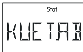
Odpojení kolektoru – nadměrná teplota je aktivní
