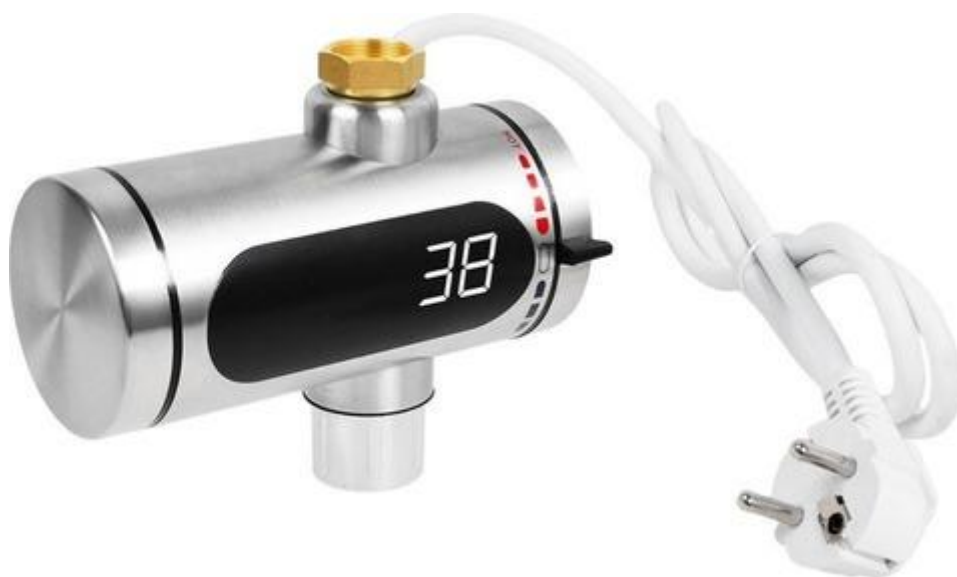
Obr. 17 Tento malý kompaktní průtokový ohřívač je možné přes instalační vsuvku napojit i místo perlátoru do stávající výtokové armatury. Byť se na stupnici může nastavit i teplota vyšší než 38 °C, tak s výkonem 3 kW moc takto teplé vody nepoteče. (Zdroj: Nabídka na e-bay.de)
