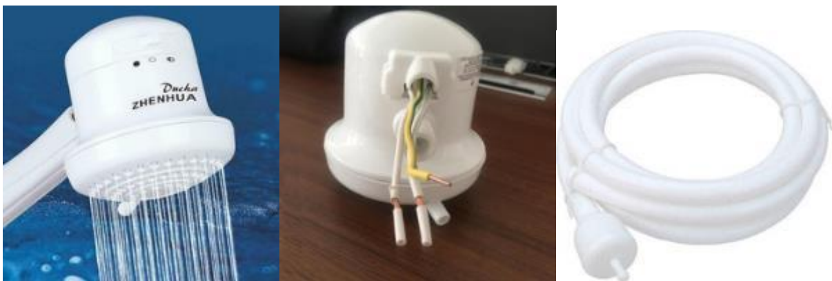
Obr. 15 Designově hezký průtokový ohřivač vody, který je součástí sprchové hlavice. Napětí 110 Volt, výkon 5400 W. Takové řešení se nabízí přes e-shopy. Konstrukční provedení neodpovídá našim bezpečnostním předpisům a problémy budou s napětím, když u nás je 230 V. Oproti řešení na obr. 14 je o něco bezpečnější, protože zapínání a vypínání ohřevu se řeší neelektrickým tlakovým spínačem přes hadičku. (Zdroj: Nabídka na e-bay.de)
