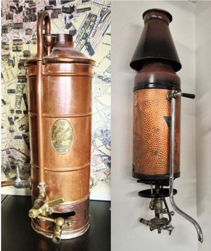
Obr. 3 Příklady historických plynových průtokových ohřivačů W.J.Davis, Velká Británie (vlevo), Junkers, Německo (vpravo) (Foto a copy: autor. Plynárenské muzeum, Pražská plynárenská a.s.)
