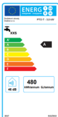
Obr. 2: Energetický štítek se zátěžovým (vytáčecím) profilem u průtokového elektrického ohřivače vody PTO-T
