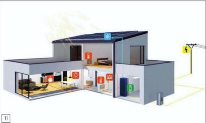
**1] DOMÁCÍ SYSTÉM** ukládání energie v podobě bateriové stanice přináší soběstačnost a značnou úsporu. První vlaštovkou společnosti Fenix je typ AES 10 s výkonem 10 kW a kapacitou úložiště 11,25 kWh. Navíc se jedná o modulární systém, jehož kapacitu bude možné rozšířit na 22 kWh. Dodává se v provedení „all-in-one“. Konkrétní informace na FENIX GROUP, [www.fenixgroup.cz](http://www.fenixgroup.cz)
